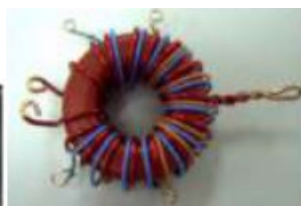
Detalle de la construcción final de L1 + L2 + L3 con terminal de masa (GND) que irá atornillado al gabinete de aluminio como puede verse en la Fig. 4.
