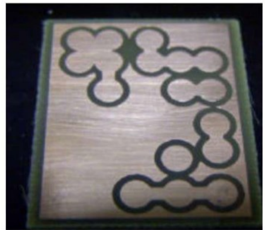
Fig. 2 - PCB diseñado con KiCAD y PCB real para el montaje de los componentes del medidor de SWR. Los "pads" de conexión de 7 mm de diámetro aprox. y las pistas de 3 mm (estas medidas no son críticas). Se recomienda estañar previamente todos los "pads" para facilitar el montaje de los componentes.
