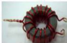
Toroide T106-2 con 16 vueltas de alambre de 1 mm (8 + 8 vueltas con respecto a terminal de masa)
