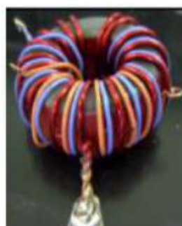
Detalle de la construcción final de L1 + L2 + L3 con terminal de masa (GND) que irá atornillado al gabinete de aluminio como puede verse en la Fig. 4.
