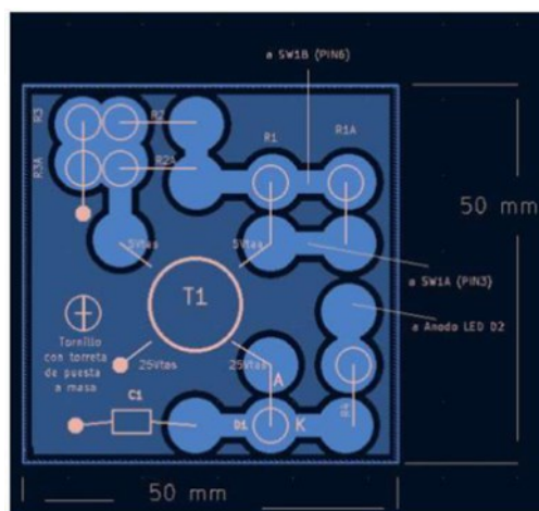
Fig.3 – Distribución de componentes en el PCB. R1 a R3 1W carbón.
