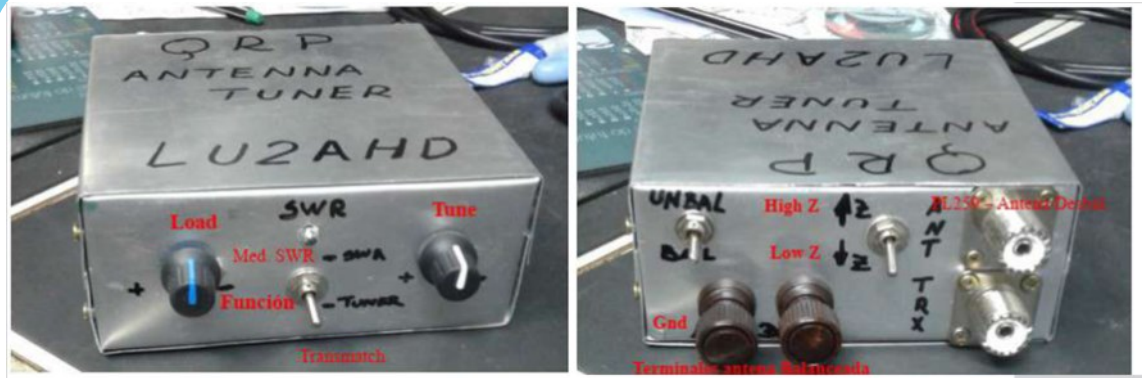
Vistas finales del Transmatch "NorCal BLT Tuner" versión LU2AHD terminado....
