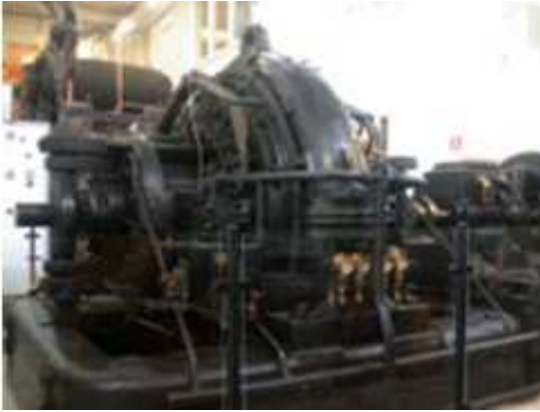
El alternador Alexanderson de Grimeton Radio
