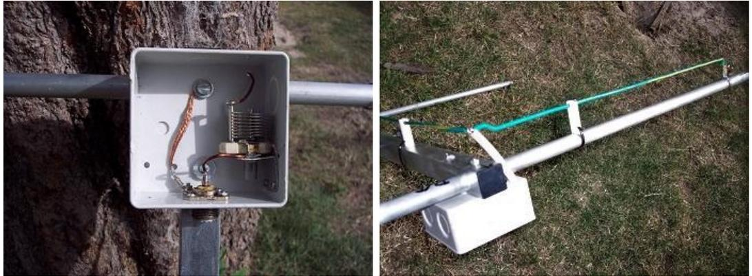
La adaptación puede hacerse mediante un gamma match o un capacitor variable. En este caso se decidió por este último colocado dentro de una caja estanca del tipo para instalaciones eléctricas.
