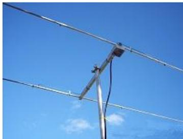
La antena HB9CV es una variante de la Yagi introducida por Rudolf Baumgartner HB9CV, en 1956. Originalmente pensada para "direction finding" o "caza del zorro", es una antena ideal para las bandas de VHF, UHF y SHF. Incluso hay quienes las han construido para las bandas de HF con excelentes resultados.
