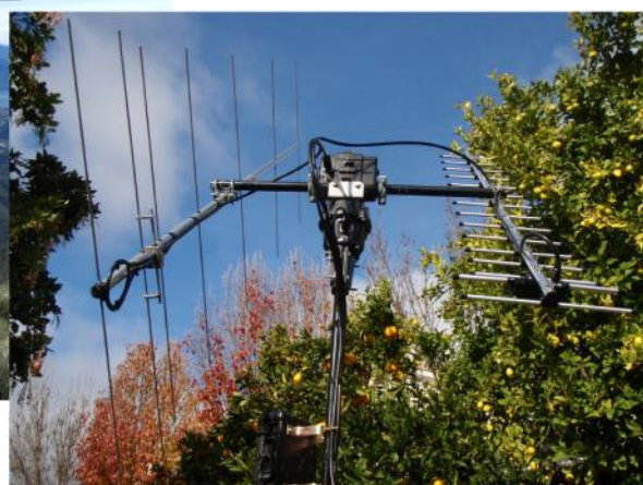
Comunicando vía satélite en VHF/UHF
