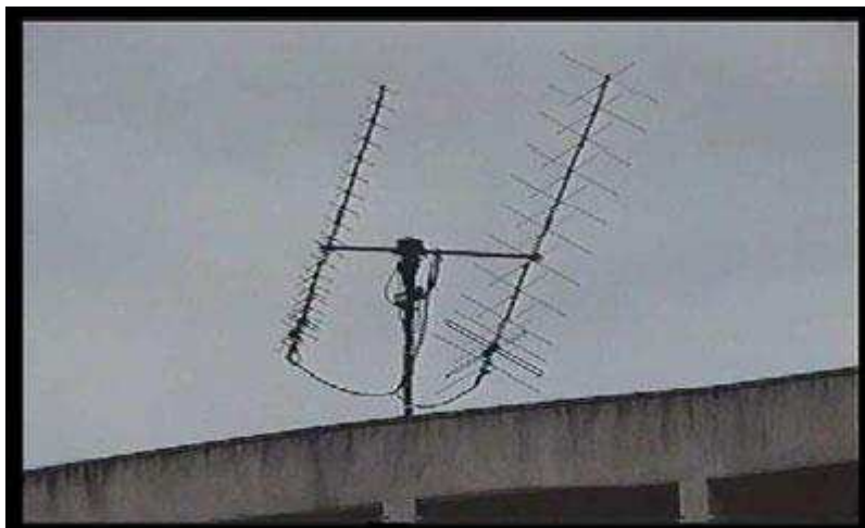
Ilustração 21 – Antenas de VHF e UHF cruzadas faseadas em polarização axial direita para satélite. Com rotor azimutal e elevação.
