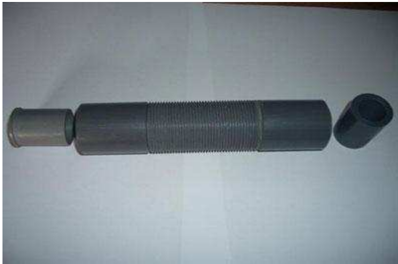
Ilustração 2 - Bobina com a rosca espaçada 1m/m e os casquilhos para receber os tubos de 20 e 25 m/m de diâmetro
