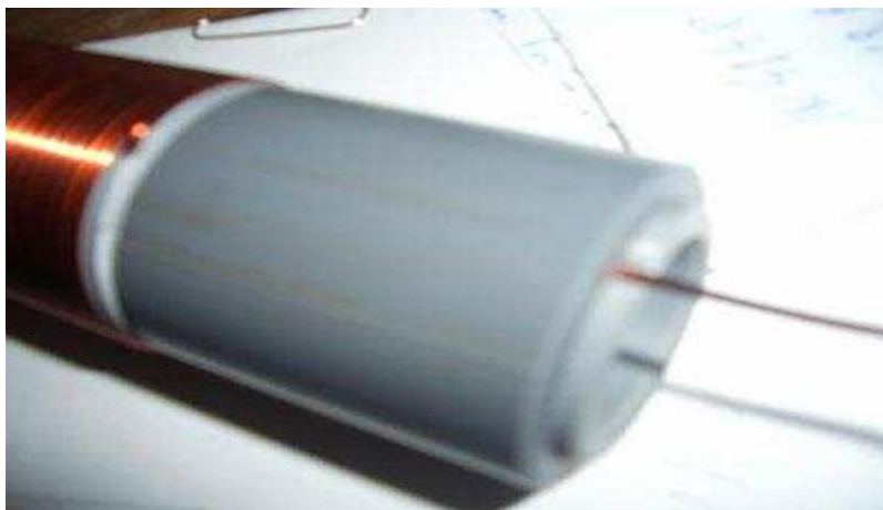
Ilustração 1 - Ponta da bobine com o casquilho com rasgo para a passagem do fio para a ligação ao tubo de alumínio, o fio passa entre o casquilho e o tubo da bobina.
