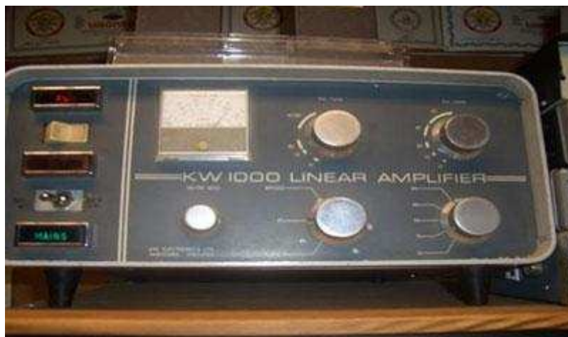
Ilustração 14 – Linear a debitar 900 W contínuos na antena
