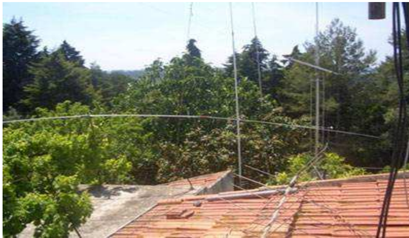
Antena dipolo rígido de 80mts em fase de experiência a 1mts do terraço que se vê na horizontal.
