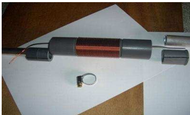
Ilustração 7 - BOBINA COM PASSO DE ROSCA ESPAÇADO 1M/M E CASQUILHOS PARA OS DIÂMETROS DOS TUBOS DE ALUMÍNIO
