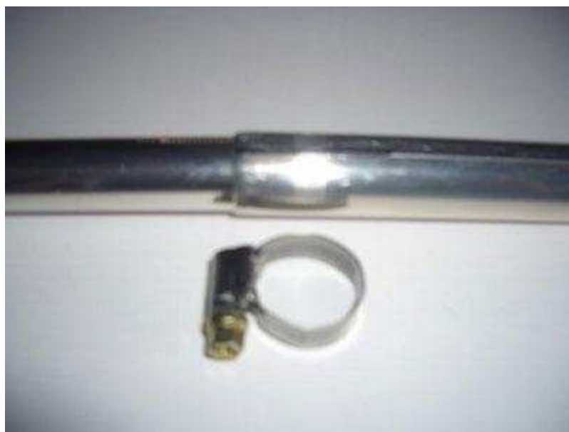
Ilustração 6 - UNIÃO DOS TUBOS DE ALUMÍNIO COM ABRAÇADEIRA (Telescópios)
