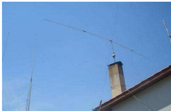
Antena dipolo rígido dos 40 mts no rotor. Total 8,30m.
