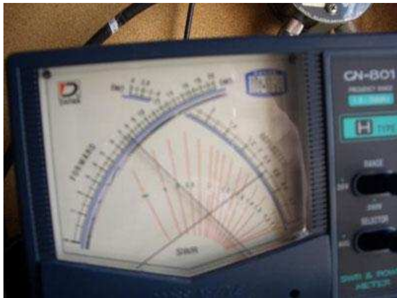
Ilustração 8 - 750 WATTS 1.3 SWR 7.099 MHZ
