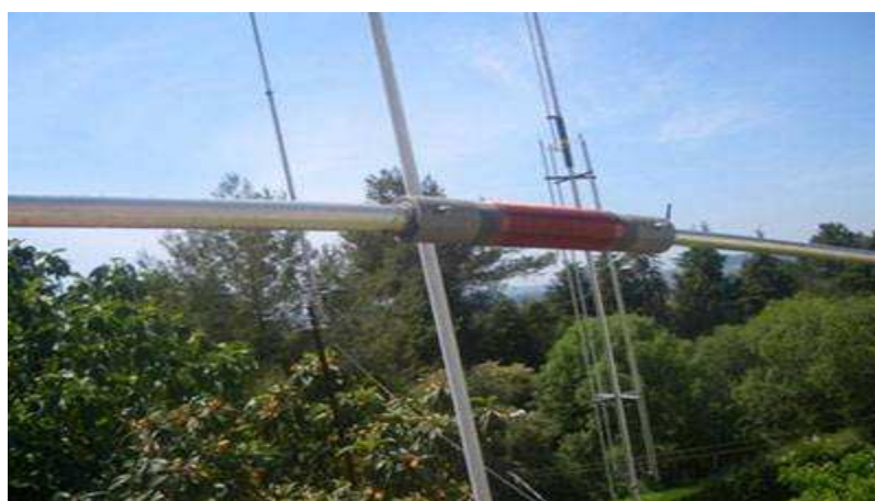
Bobina da antena dos 80 mts. 64 espiras
