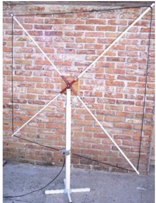
Para ello, el largo del conductor no debe tener mas de  $0,037\lambda$ , la máxima dimensión práctica para sintonizar el elemento para su resonancia.
