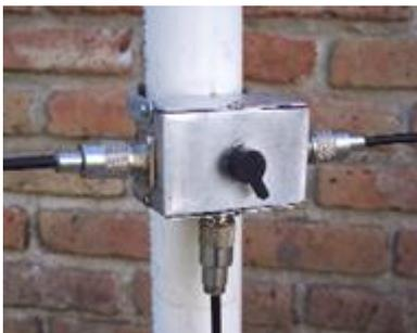
El ejemplar que se muestra fue armado para la banda de 160m a la frecuencia de 1.810KHz. El cuadro tiene 6m de longitud de cable RG59, (1,5m de lado), un condensador variable de 650pF sacado de un receptor de transistores, colocado dentro de una caja de aluminio en la que se le colocan 3 conectores coaxiales de chasis. La bajada esta hecha con cable RG58 de 50Ω del largo necesario (puede usarse
