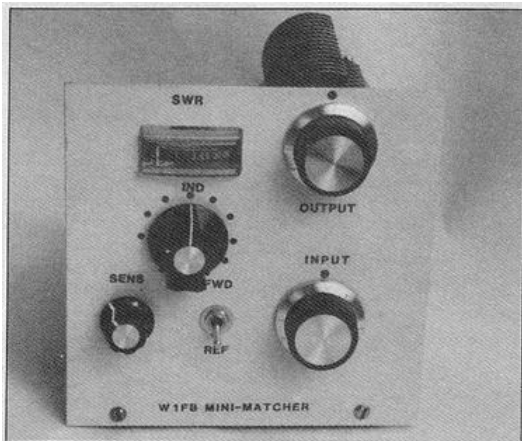
La vista frontal del acoplador presenta una distribución equilibrada de los mandos. El tamaño del aparato (135 x 130 x 110 mm) justifica la denominación de «miniacoplador».
