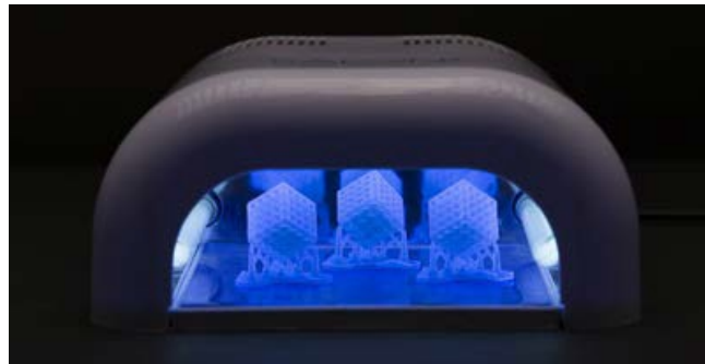
SLA imprime en una estación de curado UV. El post-curado UV finaliza el proceso de polimerización y se estabiliza las propiedades mecánicas.
