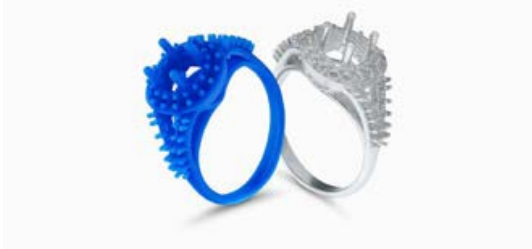
Joyas impresas de resina moldeable para fundición de inversión directa y el anillo terminado.
