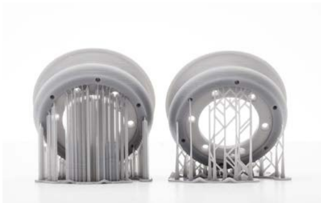
Ambos sistemas SLA usan estructuras de soporte para unir partes a la plataforma de construcción.
