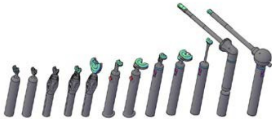
Iteraciones consecutivas de Sutru, un dispositivo de sutura quirúrgico automatizado prototipado en Formlabs Impresoras SLA.
