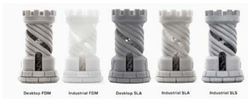
Las torres se imprimieron a una altura de capa de 100 micrones en un FDM de escritorio e industrial, SLA de escritorio (Form 2), Impresoras SLA industriales e impresoras 3D SLS industriales.
